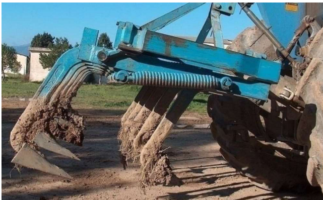
Décompacteur - Source : Giancarlo Dessì, licence CC BY-SA 3.0
